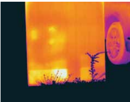
Diese heißen Stellen scheinen auf ineffiziente Solarzellen hinzuweisen, eine nähere Untersuchung zeigt jedoch, dass mehrere dieser Stellen durch die reflektierte Wärme der vor dem Modul stehenden Personen entstanden sind.
