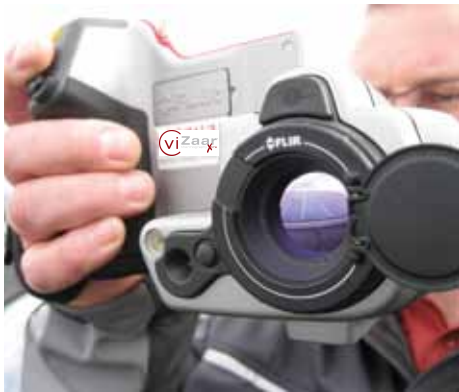
Die FLIR T335 Wärmebildkamera ist mit mehreren unterschiedlichen Wechselobjektiven erhältlich.
