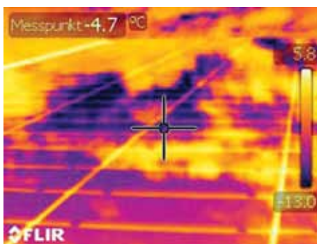
In dieser Thermal Fusion Aufnahme werden nur die heißen Stellen auf dem Wärmebild gezeigt.
