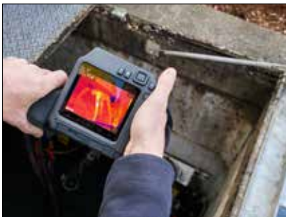
Mit ihrem um 180° drehbaren optischen Block und ihrem leuchtstarken 4-Zoll-Display lässt sich die T500-Serie in jeder Umgebung einfach einsetzen
