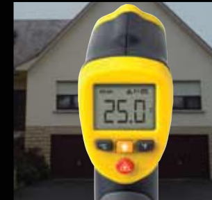
Pyrometer, Temperaturmessung an einem Punkt
