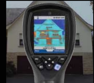
FLIR i3, Temperaturmessung an 3600 Punkten
